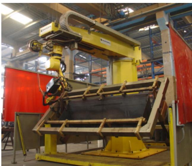
Coluna de Soldadura Rotativa
