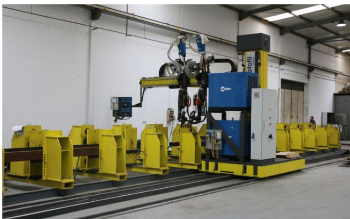
Máquina de Soldar Vigas
