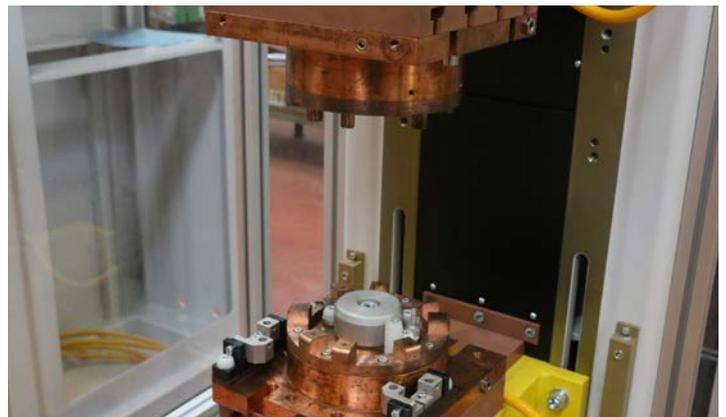
Máquina de Soldadura por Resistência
