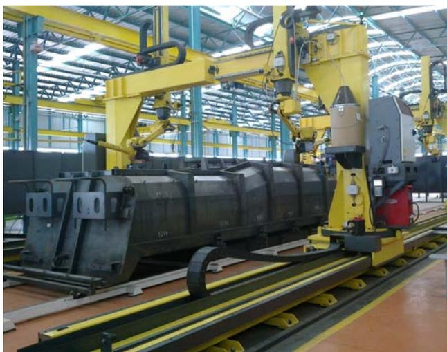
Coluna de Soldadura Robotizada
