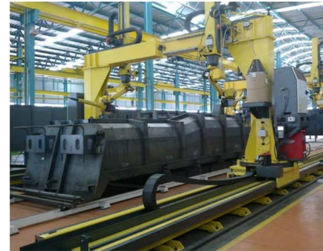
Columna de Soldadura Robótica
