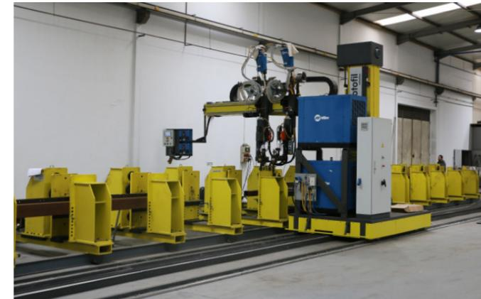
Máquina de Soldar Vigas
