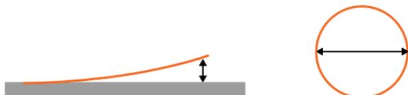
Mesurer le **diamètre du fil**, avec un micromètre, vérifiant les limites acceptables:
