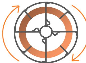
Vérifier **cast et hélix** en retirant, sans presser le fil, 4 ou 5 spires de la bobine et lancer au sol:
